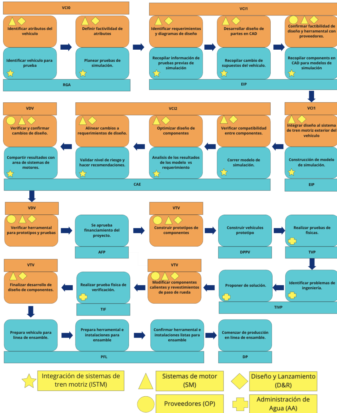
Figura 5 Diagrama ideal del proceso de enfriamiento.
