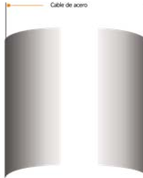
Panel suspendido por cable de acero
