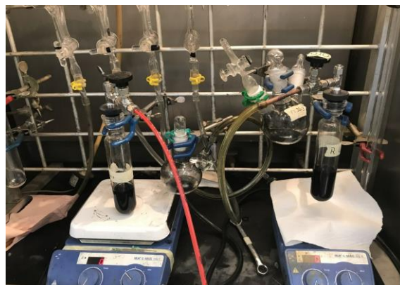
Figura 9: Imagen de los reactores Fisher-Porter en presencia del precursor de Pd, carbón vólcan, THF anhidro y el estabilizante.
