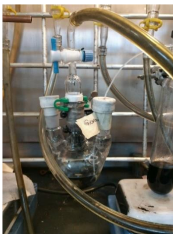
Figura 11: Imagen de la separación del pentano sobrenadante de la solución coloidal en atmósfera de N_2 .
