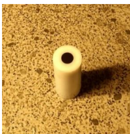
Figura 28. Imagen del depósito de la suspensión en electrodo de trabajo de carbón vítreo en teflón previamente pulido a espejo.
