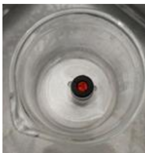
Figura 27. Imagen de la homogenización de suspensiones en baño de ultrasonido.
