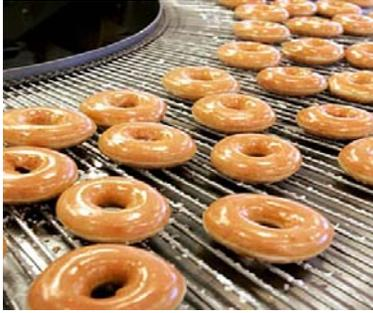
Por lo que se refiere a la elaboración de las donas, al completarse el esponjado se hacían pasar por una banda transportadora donde se les freía de un lado y del otro, se dejaban escurrir y secar y se inspeccionaban. Las donas destinadas al glaseado se dirigían a una cascada de cobertura de azúcar caliente; las demás a otra área de la sección del horneado para rellenarlas y/o enfriarlas.
