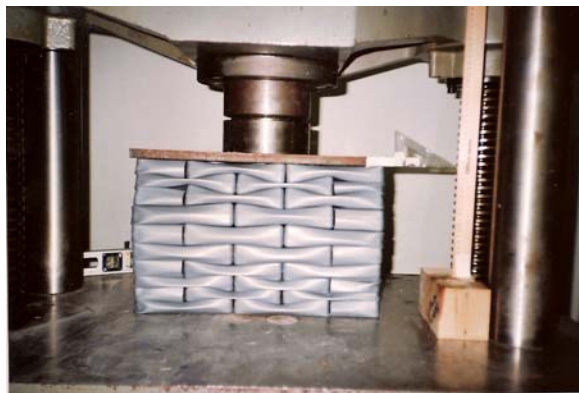
Figura 16 Murete de mampostería de PEAD a Compresión* ,
