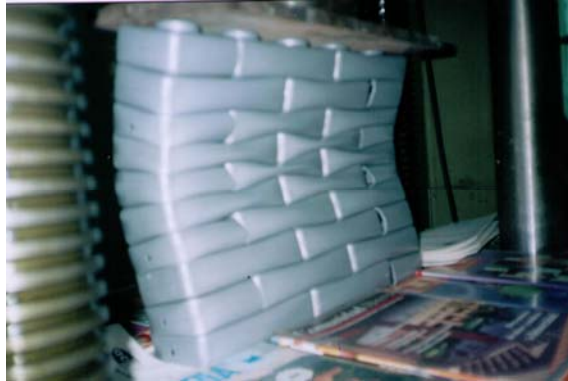
Figura 14 Murete de mampostería de PEAD, a Compresión , presentando pandeo.
