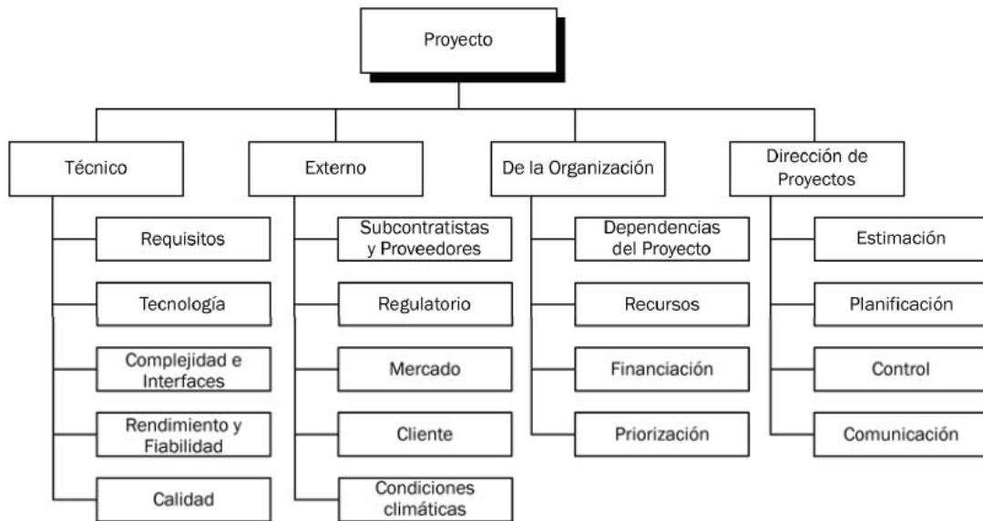
Gráfica 3-1: Ejemplo de una Estructura de Desglose del Riesgo (RBS).
